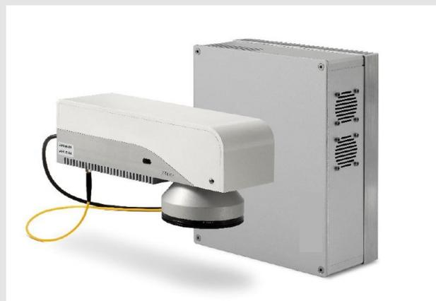
LD è una sorgente di marcatura laser a Q-switch attivo da 6 e 10 W basata sulla tecnologia DPSS (Diode Pumped Solid State), appositamente progettata per l'integrazione in macchine desktop, sistemi di test e collaudo da banco, oltre che per integrazione standard in linee di produzione o all'interno di classiche safety box di protezione in Classe 1.
